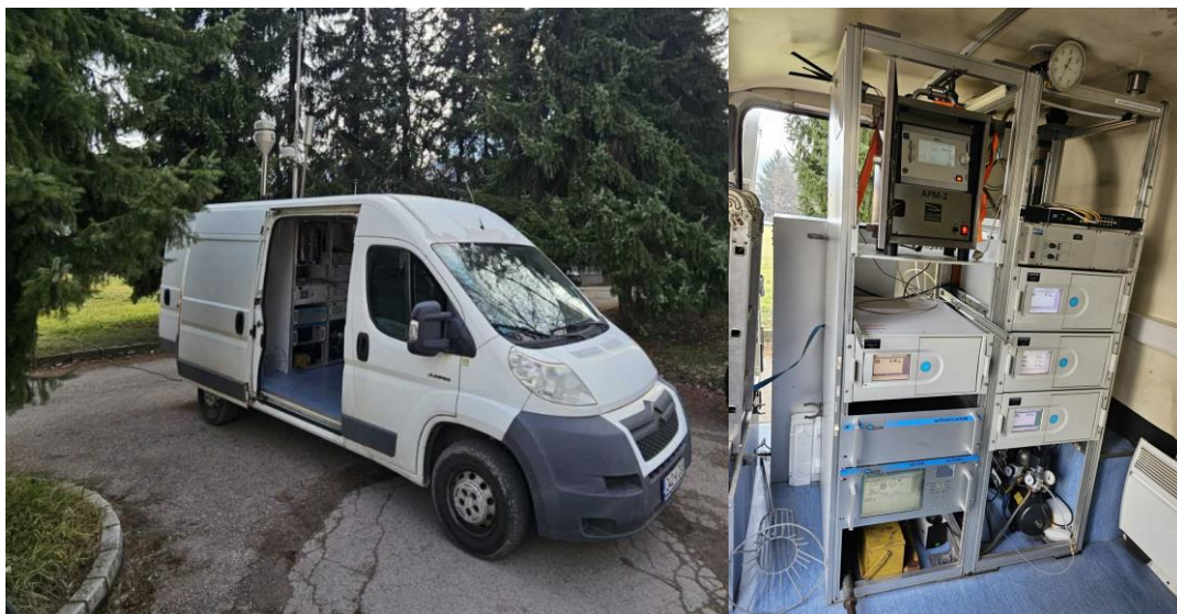
Slika 15. Mobilna automatska stanica za monitoring kvaliteta zraka
