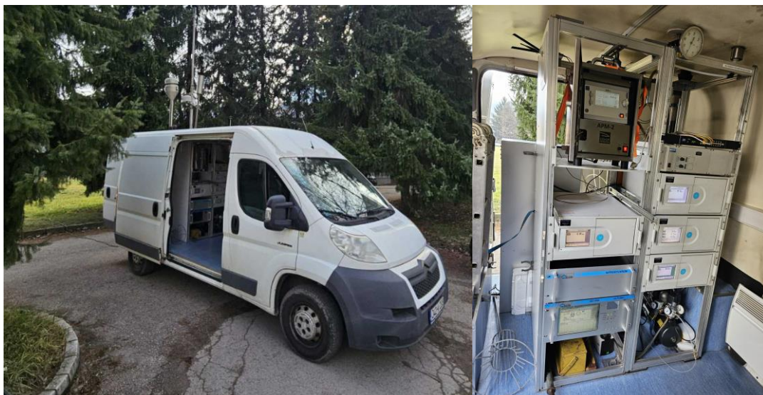
Slika 15. Mobilna automatska stanica za monitoring kvaliteta zraka
