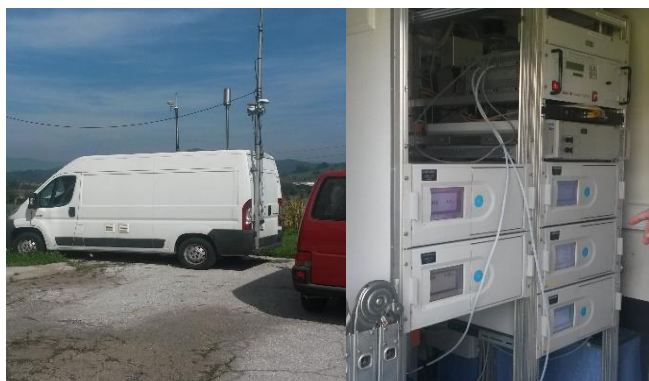
Slika 14. Mobilna automatska stanica za monitoring kvaliteta zraka
